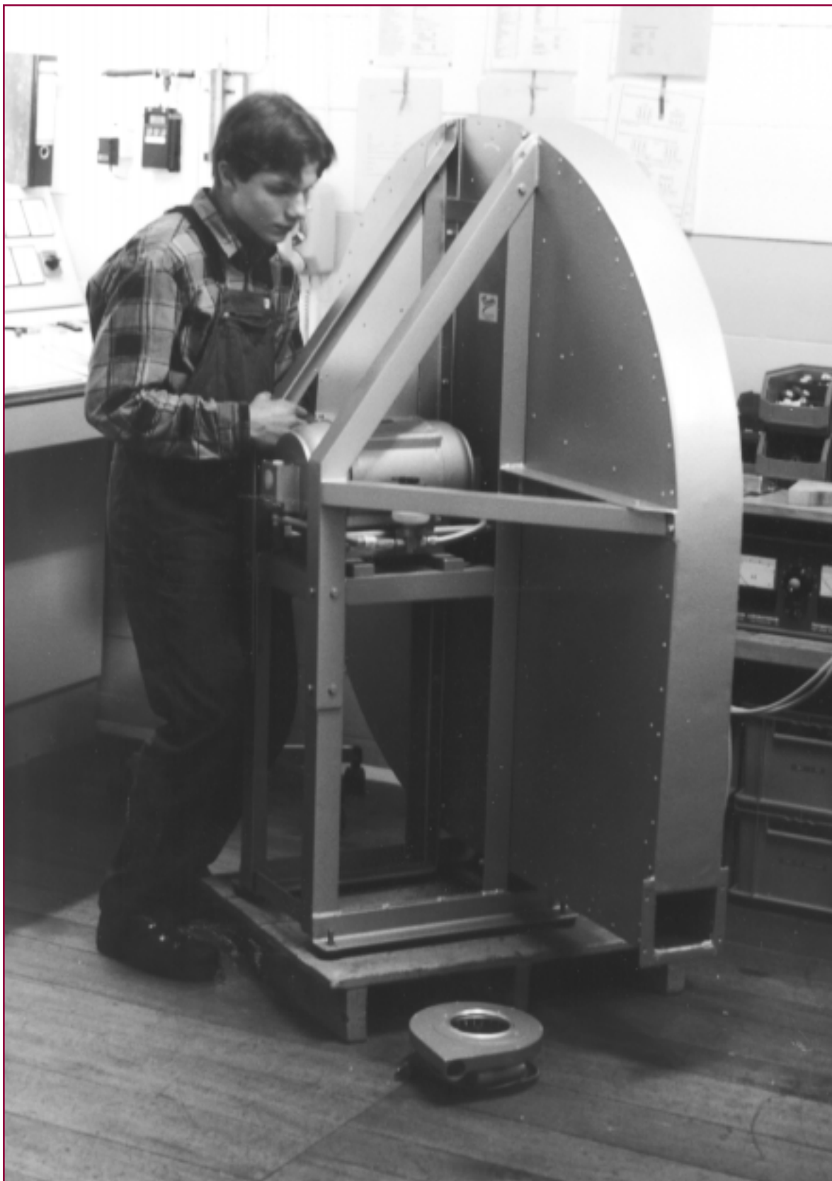
Größter und kleinster Laukhuff-Winderzeuger: Ventus mit 420 mmWS Druck, Gehäusehöhe 1,47 m und Mini-Ventola.
